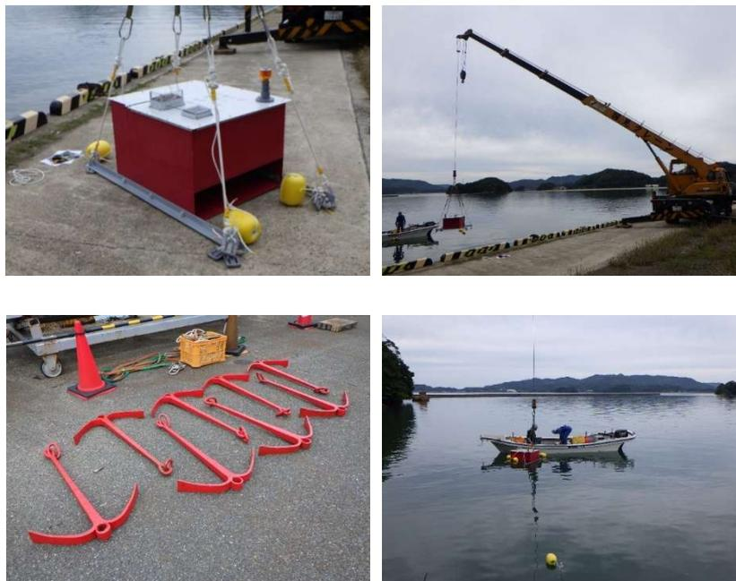
図2 (左上)試験に使用した波力発電ブイ。(右上)岸壁クレーンからのブイ吊上げ。
